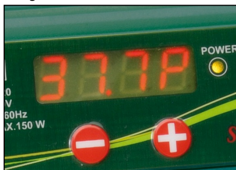
Display med temperatur i programmodus (temperatur etterfulgt av "P")
